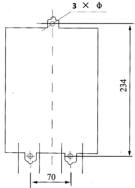
转换器安装尺寸(墙壁挂式)
